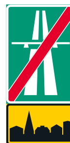
Kuva 97. Taajamaan johtavalla yksikaistaisella erkanemistiellä merkki E16 sijoitetaan normaalikokoisena tien oikealle puolelle yleensä pienikokoisen merkin E22 (taajama) kanssa samaan pylvääseen.
