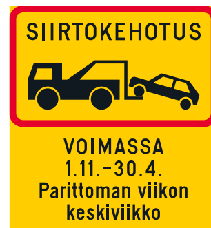
Kuva 172. Siirtokehotuksen 113 voimassaoloaika voidaan kertoa merkin yhteydessä.
